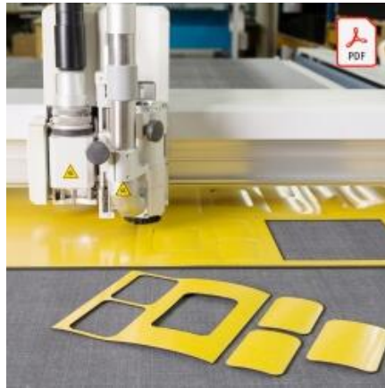
Zuschnitt Flachdichtung EPDM Vollgummi 65° Shore A einseitig selbstklebend - PDF Upload
